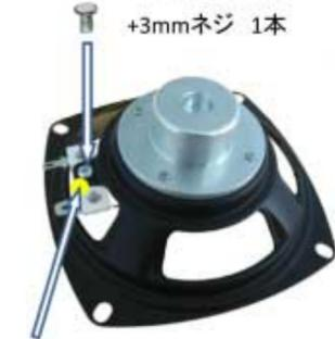
端子板が回らないように端子板とフレームの間に少量の接着剤を塗布し接着します。
