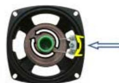
治具をつまんで回転し図のようにフレームの端子板取付位置と端子板の位置を合わせます。
