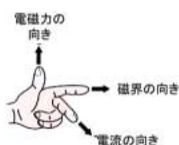
磁界の向き(黄)が下のような状態の中で矢印(赤)の方向に電流を流すと
